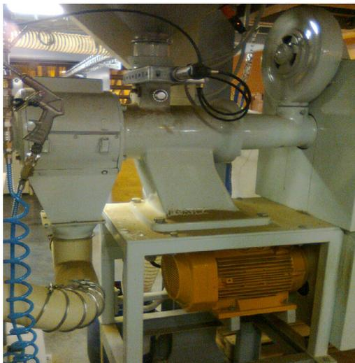
**Рис. 3.** Лабораторная шлифовальная установка
